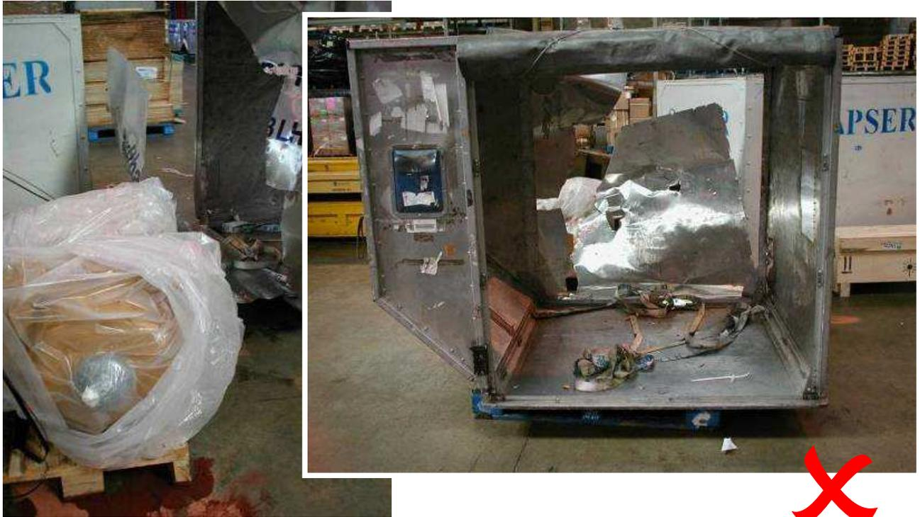
Il collo (come si vede nella foto a sinistra) era assicurato solo con 2 cinghie, si è mosso durante l'atterraggio, danneggiando il contenitore (come indicato nella seconda foto sulla destra) e finendo non legato al interno della stiva del aeromobile, causando un grave problema di sicurezza di volo.
